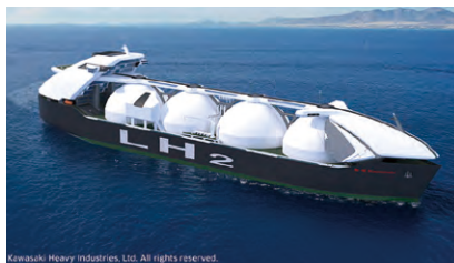
160,000m 3 型液化水素運搬船コンセプト図 提供：川崎重工業株式会社
