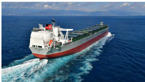
LNG燃料ケープサイズバルカー“CAPE HAYATE”
