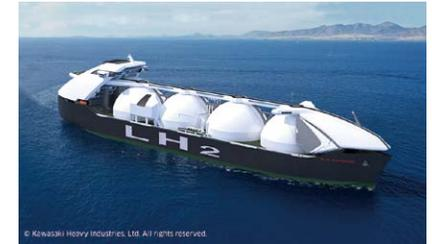
160,000m<sup>3</sup>型液化水素運搬船コンセプト図
