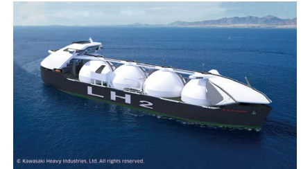
160,000m 3 型液化水素運搬船コンセプト図 提供：川崎重工業株式会社
