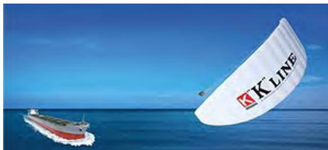
本船船首部に搭載されたカイトが、一定条件の風力・風向の下、ブリッジ(船橋)からの操作で展張し、風力をを利用して本船の推進力を補助
