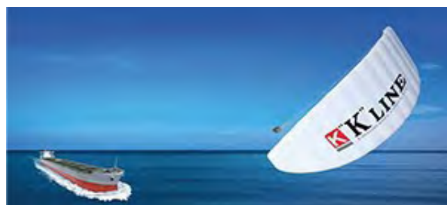
本船舶首部に搭載されたカイトが、一定条件の風力・風向の下、ブリッジ(船橋)からの操作で展張し、風力を利用して本船の推進力を補助
