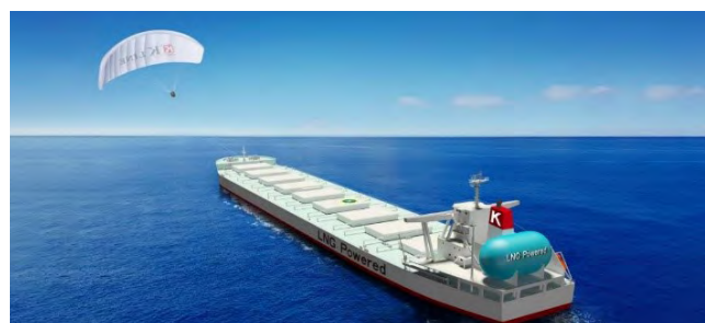
本船舶首部に搭載されたカイトが、一定条件の風力・風向の下、ブリッジ(船橋)からの操作で展張し、風力を利用して本船の推進力を補助
