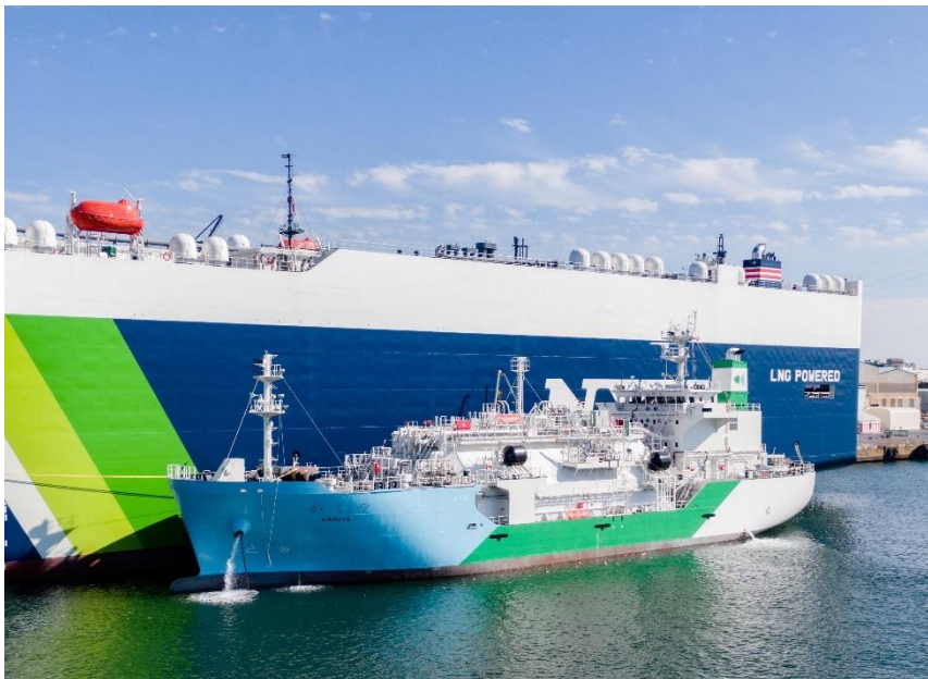
LNG 燃料供給を行う「かぐや」 セントラル LNG マリンフューエル株式会社提供
