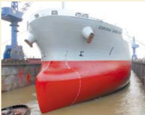
ドックでシリコン塗料（赤色）による塗装工事を行った後の CORONA EMBLEM
