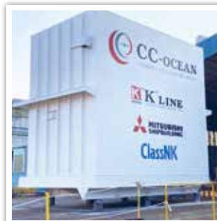
搭載前のCO 2 回収装置
