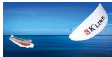
自然エネルギーを利用する 自動カイトシステム“Seawing”
