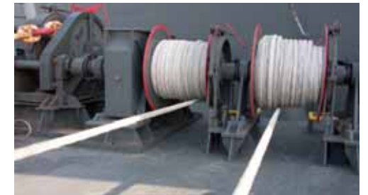
電動ムアリングウインチと係留索(船首)
