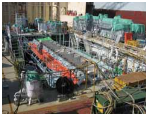
メインエンジン搭載中(船上でエンジンを組み立てていく)
