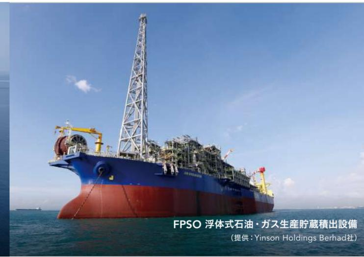
FPSO 浮体式石油・ガス生産貯蔵積出設備
