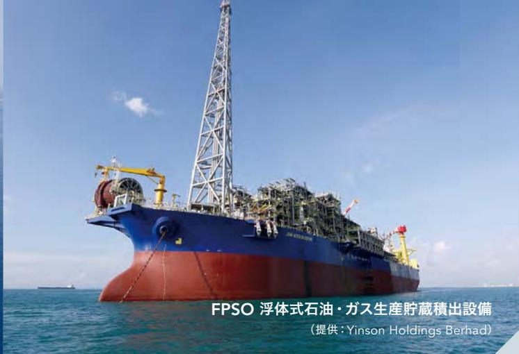
FPSO 浮体式石油・ガス生産貯蔵積出設備
