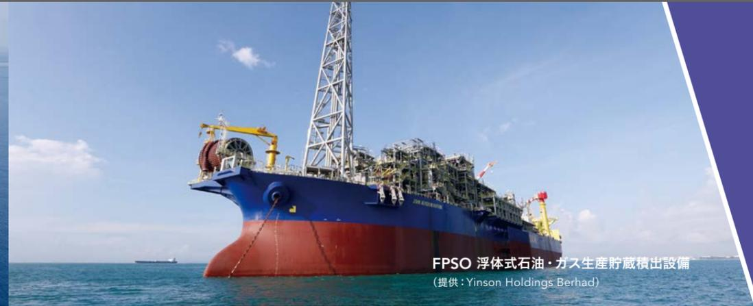
FPSO 浮体式石油・ガス生産貯蔵積出設備
