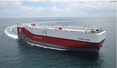
LNG燃料自動車専用船 POSEIDON HIGHWAY
