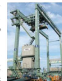
え、動力として再利用するもので、従来型に比較し、燃料消費量やCO<sub>2</sub>などの排出ガスが半減し、また改良型エンジンにより騒音の大幅な低減を図っています。
