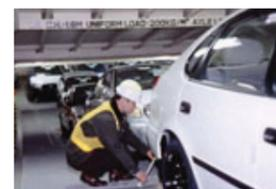
自動車専用船内の車両固定状態の点検
