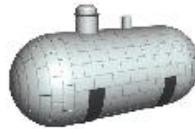
円筒型の蓄圧式(6気圧)2基を搭載。万一、衝突事故が発生した場合にも安全性が保てるよう、外板や船底から一定の距離を置いた位置に配置されます。また、2つのLNG燃料タンクにはそれぞれ独立した区画を設けるなど、厳しい安全基準にも対応しています。更に、安全性を高めるため、燃料パイプを2重にするなどの対策も施しています。
