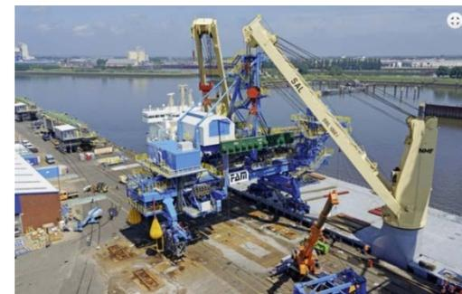
シップローダー（鉄鋼石等バルク貨物を船船へ積み込む港湾設備）
