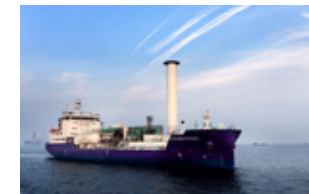
Northern Lightsプロジェクトに従事する液化CO 2 船「NORTHEN PIONEER」(提供：Northern Lights JV DA)
