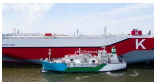
LNG燃料供給船「かぐや」とLNG燃料焚き自動車船「CENTURY HIGHWAY GREEN」(提供：セントラルLNGマリンフェューエル社)
