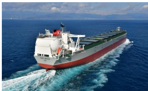
ケープサイズ(21万DWT LNG燃料船“CAPE HAYATE”)
