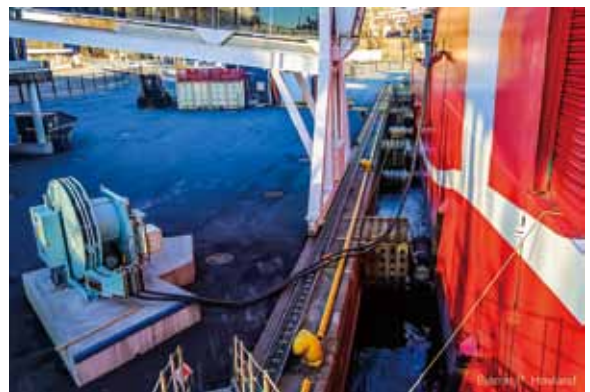
陸上の設備で給電されているオフショア支援船 An offshore support ship fed by the land facility
