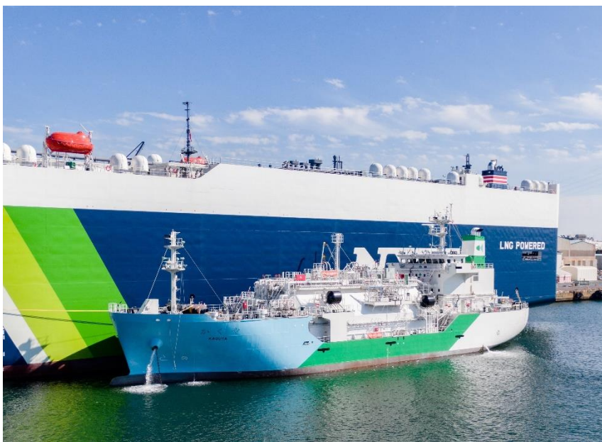
“ Kaguya ” supplying LNG fuel
